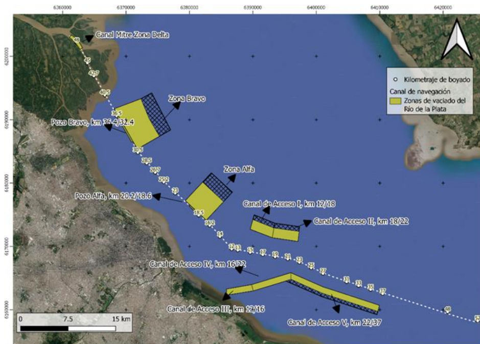
Figura 3.1. Zonas de vaciado para los canales Mitre y de Acceso. Fuente: Estudio Latinoconsult-VNT.
