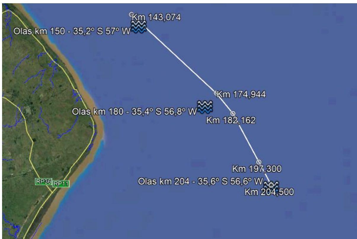
Figura 24: Puntos de referencia tomados para el análisis estadísticos del clima de olas, sobre la base global Waverys. Fuente: elaboración propia.
